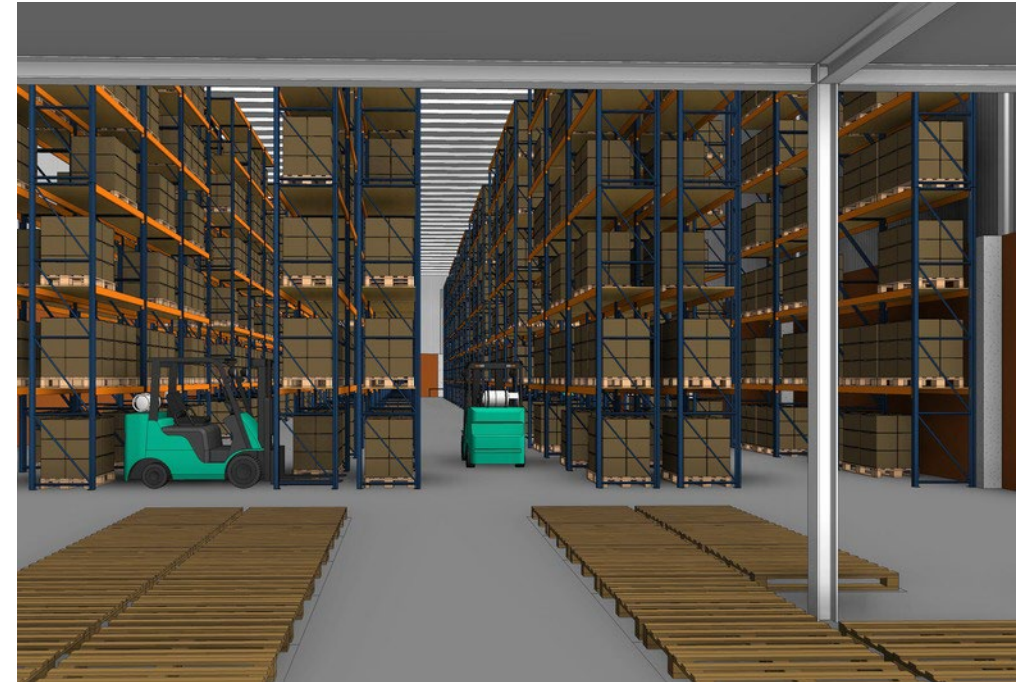
Interior de nave · racks, montacargas y altura operativa ≈ 10 m
